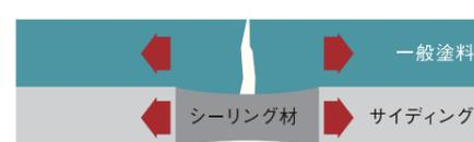
弾性を有しないため、塗膜が目地シーリングの動きに追従できず、目地上の塗膜にひび割れが生じ、防水性が低下します。
