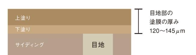
リファイン弾性システム工法は、目地部の塗膜の厚みが約**140%UP**し、目地追従性を高めます。
