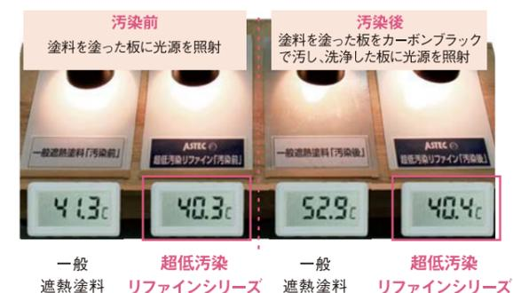
4枚の板に同量の光源を照射したところ、超低汚染リファインシリーズを塗った板は、汚染前・汚染後でほぼ温度差がなく、遮熱性が維持されていることが実証されました。※1 社内試験にて実施
