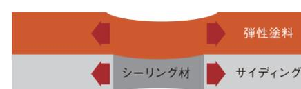
優れた弾性によって、塗膜が目地シーリングの動きに追従し、目地上の塗膜にひび割れが生じず、防水性を維持します。
