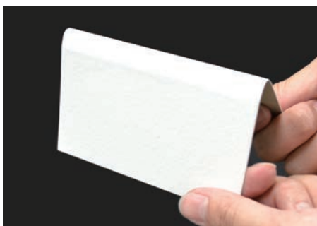
◀超低汚染リファインSi-IRを塗布した鉄板を折り曲げた様子
