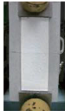
ひび割れ追従試験(ゼロスパンション試験)
